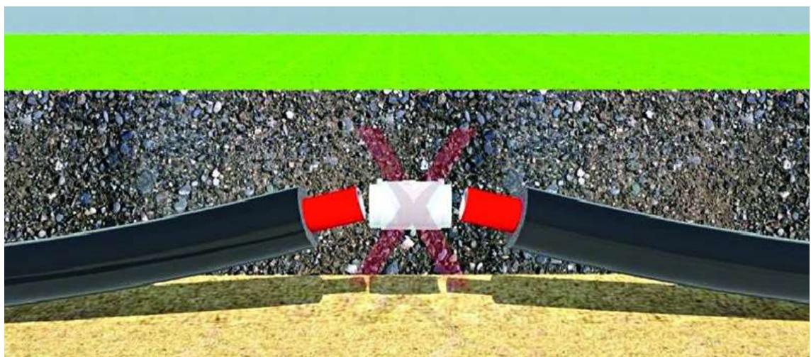
Неправильно. Фитинг для электрофузионной сварки нагружен.
