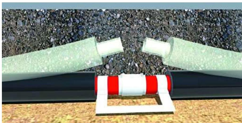
Правильно. Вариант 1. Использовать центрирующие струбцины во время сваривания до полного остывания.
