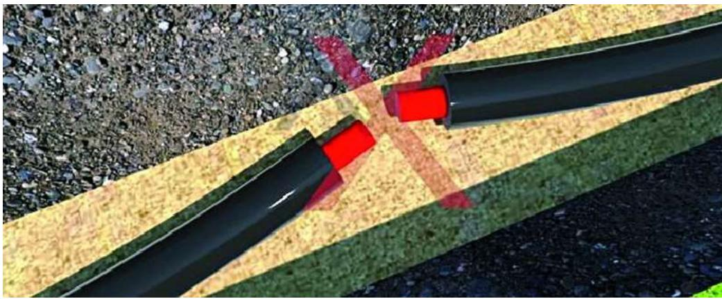
Неправильно. Трубы лежат на плоскости, но изгиб от остаточной деформации в одну сторону.
