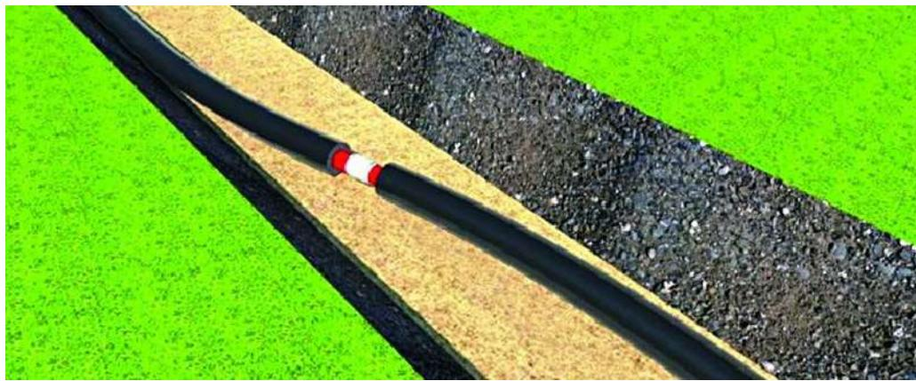
Правильно. Вариант 2. Прокладывать трубы изначально с изгибом трубы от остаточной деформации в противоположные стороны.
